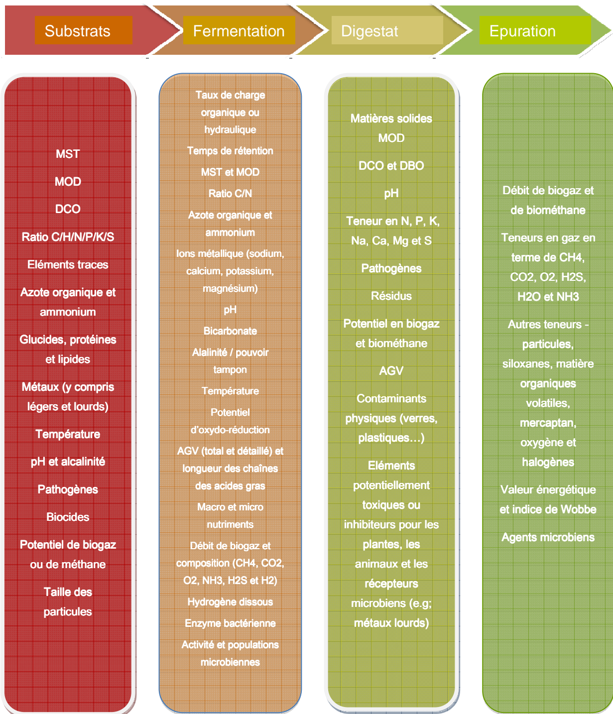
Figure 3 – Paramètres de contrôle pour chaque étape/matrice pertinente de l'exploitation d'une unité de méthanisation.
