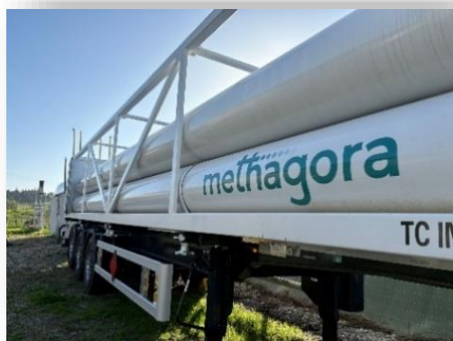
Citernes prêtes à recueillir le biométhane épuré, afin d'acheminer les sites du Hub d'Ardoix © Methagora
